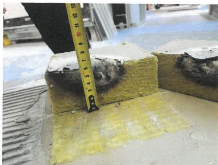
Рис.№ 22. Замер глубины деструкции SW Isoroc
